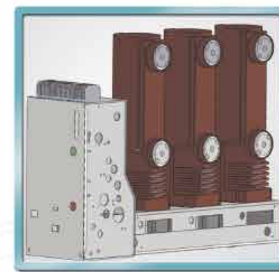
主回路侧装置：断路器ABC三相采 用前中后的布置形式，断路器整机宽 度尺寸大幅缩小。
